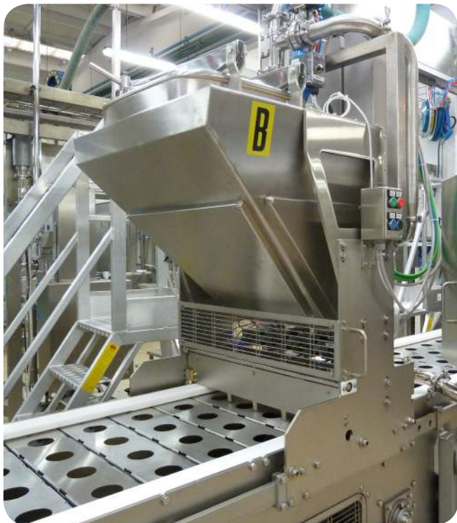
Tramoggia per creme, con sonda di livello Hopper for creams, with level probe Hopper pour les crèmes, avec sonde de niveau
