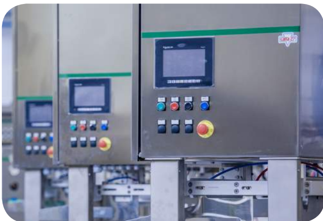
Gestione automatica con PLC PLC automatic management Gestion automatique avec de PLC
