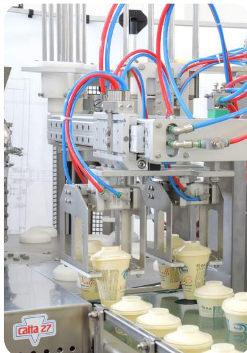
Scarico automatizzato Automatized unloading station Robot decharge
